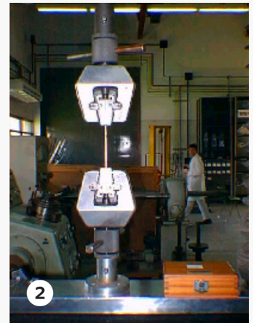
Foto 1: Taller del INTI. Máquina de tracción estática. Foto 2: Clavo en tracción.
