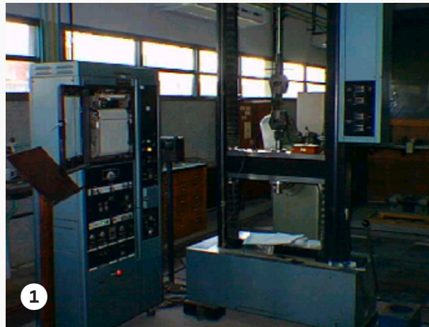
Foto 1: Taller del INTI. Máquina de tracción estática. Foto 2: Clavo en tracción.
